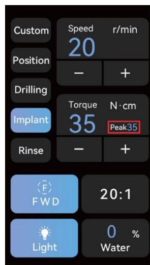
그림 12. 피크 토크 표시
